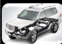
Estructura de carrocería (GOA)
